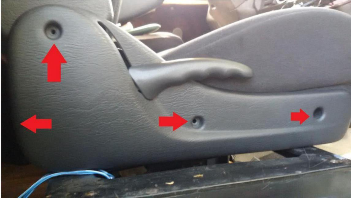
Zur Ausrichtung der Bohrlöcher die 4 Befestigungsschrauben vom Sitz von unten 2 Umdrehungen rein drehen. Hinten in das zweite (vorletzte) Gewindeloch einschrauben!
